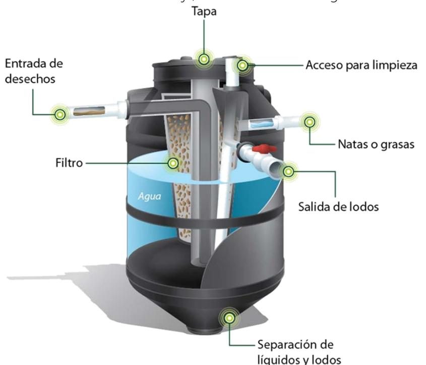
Imagen 4. Sección tridimensional del dispositivo roto moldeado seleccionado para el sistema de tratamiento propuesto.
